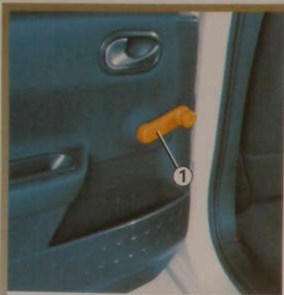
Hátsó mechanikus ablakemelő Használja a hajtókart (1).
