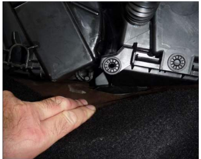
Itt a kondenzvíz kivezető gumi gallérja.
