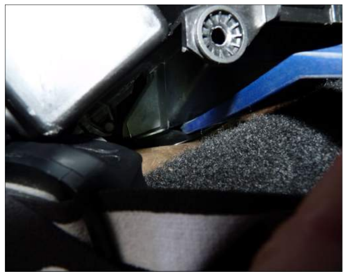
A gumi gallér és a csepptálca közé benyomva egy feszítő ék.
