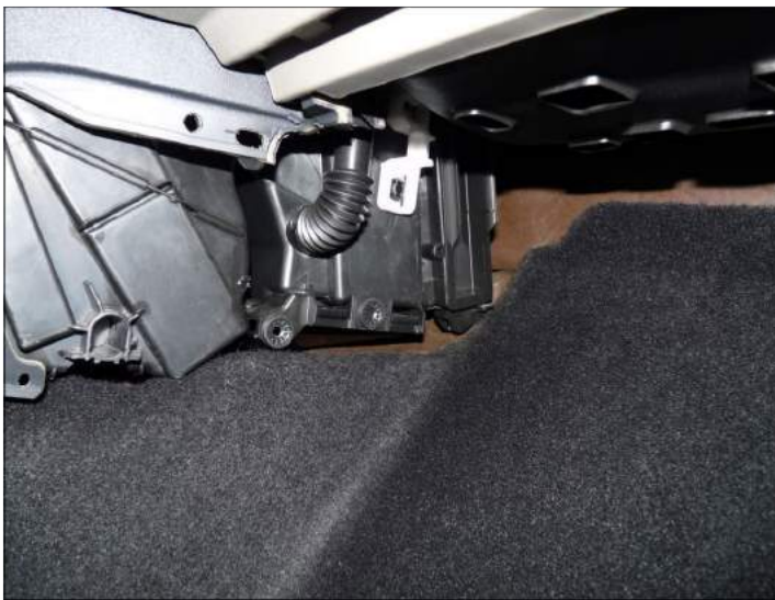
Itt látható a klíma hőcserélő doboza.
