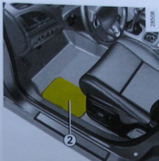
A vezetőoldali padlólemez és az utasoldali padlólemez alatt lévő rakodórekeszek fedelei 2
