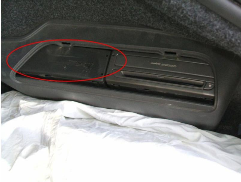
Para poder acceder a los conectores, hay que desmontar la caja de plástico (sólo enganchada por unas patillas).
